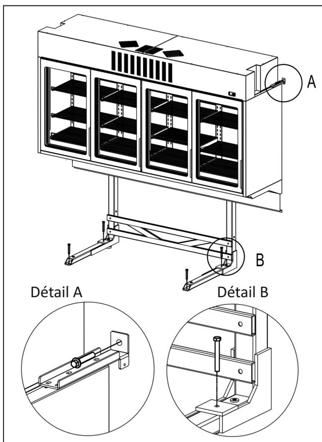
**⚠ TRÈS IMPORTANT :** La structure de support de l'armoire verticale (modèle ARV) doit obligatoirement être fixée au sol et les pièces de fixation latérale doivent être fixées au mur.
