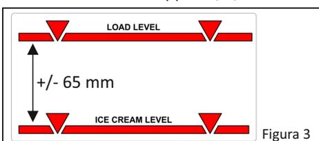
**TRÈS IMPORTANT!** Si un produit congelé dépasse le repère (Niveau de charge - Fig.3), la température minimale admissible pour les produits surgelés n'est plus garantie
