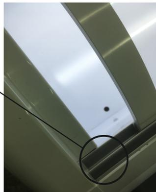
**⚠ ATTENTION!** Le cadre en plastique où les couvercles s'emboîtent dispose d'un lubrifiant spécial pour assurer un glissement en douceur. Au fil du temps, il devra peut-être être lubrifié. Au besoin, contactez le service après vente.
