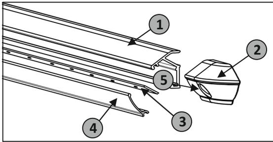
Para sustituir el led en caso de avería, desenroscar el tornillo (5) que sujeta la esquina de remate (2) desenroscar el acrílico (4) y despegar el led (3).
