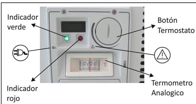
■ Indicador de color rojo **⚠** cuya función es simplemente la de informar si la temperatura interior del congelador sube por encima de valores peligrosos para los productos almacenados **¡NOTA!** En los aparatos de refrigeración (modelo ALFA), el indicador rojo se sustituye por un indicador naranja. Este nos informa de que el aparato está refrigerando.
