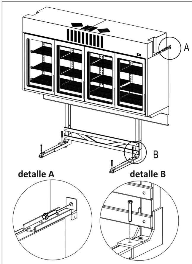
**⚠ MUY IMPORTANTE:** La estructura de soporte del armario vertical (modelo ARV) deberá ser obligatoriamente fija al suelo, así como las piezas de fijación lateral a la pared.
